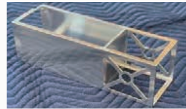
CubeSat 3U 構体切削加工例
