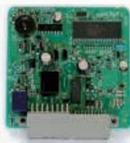
車載用制御基板
