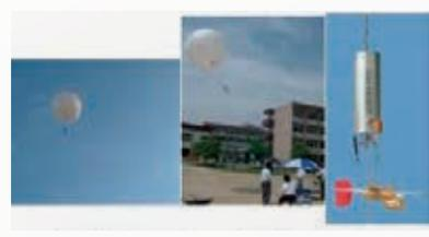
気球係留方式CO2観測システム
